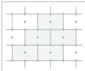
Per pannelli naturali e minerali tipo MW, utilizzare lo schema di tassellatura a "W", in cui ogni lastra è fissata con 3 tasselli, posizionati all'interno del pannello in prossimità del bordo per evitarne lo sfondamento
