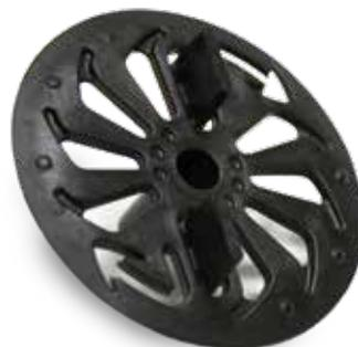
Il Tassello Steel Dryfast 8-10 assicura ottime proprietà meccaniche e consente un perfetto inglobamento nella matrice dei sistemi di rinforzo a fasce e diffusi realizzati con la gamma di reti e tessuti Geosteel, in basso spessore. Grazie alla sua composizione chimica il polipropilene è caratterizzato da una elevata resistenza all'urto e all'abrasione, un'ottima resistenza termica e una elevata durabilità.
