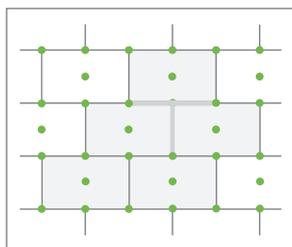
Per pannelli naturali e minerali tipo MW, utilizzare lo schema di tassellatura a "W", in cui ogni lastra è fissata con 3 tasselli, posizionati all'interno del pannello in prossimità del bordo per evitarne lo sfondamento
