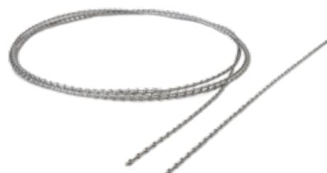
Grazie alla sua particolare geometria e processo produttivo, Steel Dryfast lavora come una vite autofilettante, ammorsandosi sul supporto, previa realizzazione di un apposito foro pilota. La barra è idonea per collegare fra di loro elementi in muratura di laterizio, terra cruda, tufo, legno e in alcuni casi anche elementi in calcestruzzo a seconda delle caratteristiche meccaniche del supporto.
