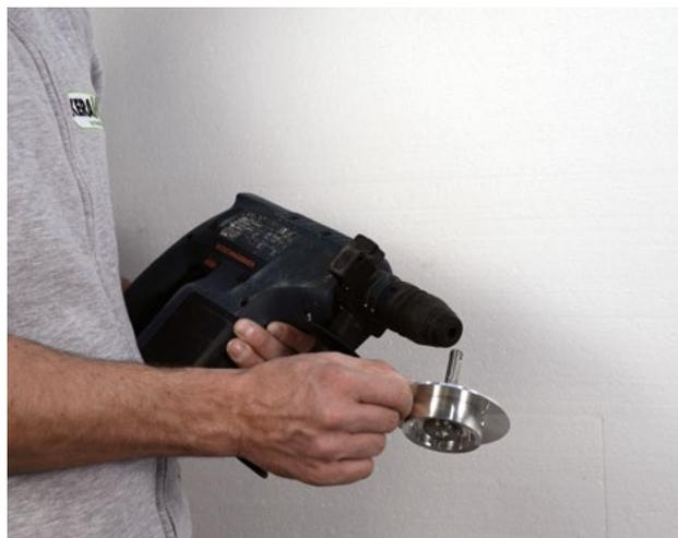
Applicare sull'avvitatore predisposto con attacco SDS la Fresa Metallica Bivalente in modalità fresa per l'infissione di tasselli avvitabili all'interno dei pannelli isolanti.
