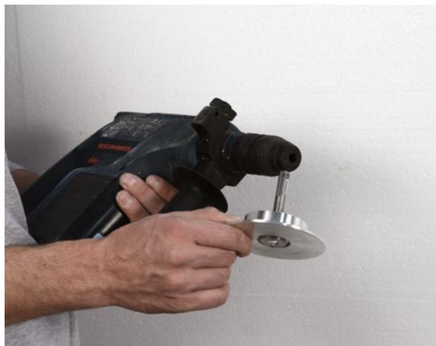
Applicare sull'avvitatore predisposto con attacco SDS la Fresa Metallica Bivalente per l'infissione di tasselli avvitabili, dotato di punta torx.
