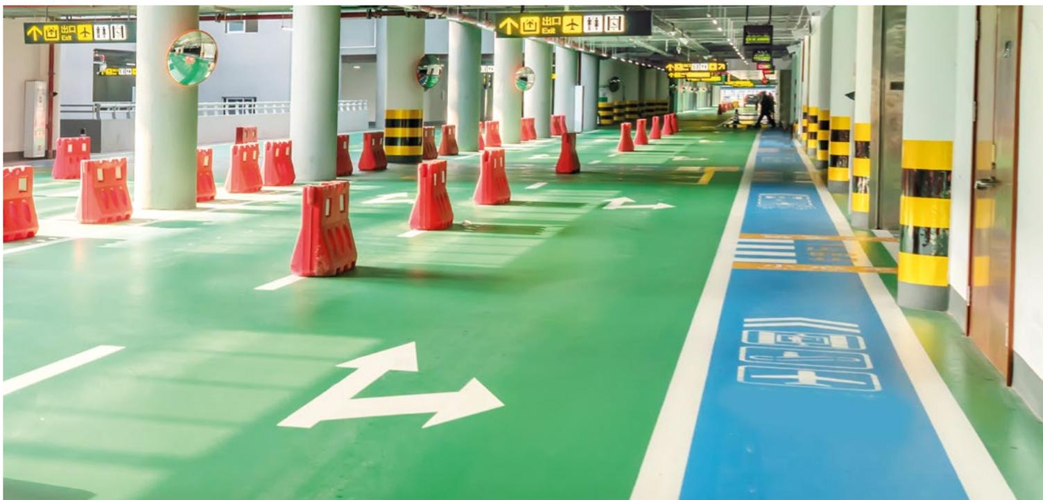
I rivestimenti in resina per pavimenti industriali furono sviluppati, in origine, per migliorare le caratteristiche prestazionali ed estetiche delle pavimentazioni in calcestruzzo. Oggi, soprattutto, offrono la possibilità di recuperare sia in ambito industriale che commerciale le pavimentazioni esistenti, spesso senza dover ricorrere a demolizioni.
