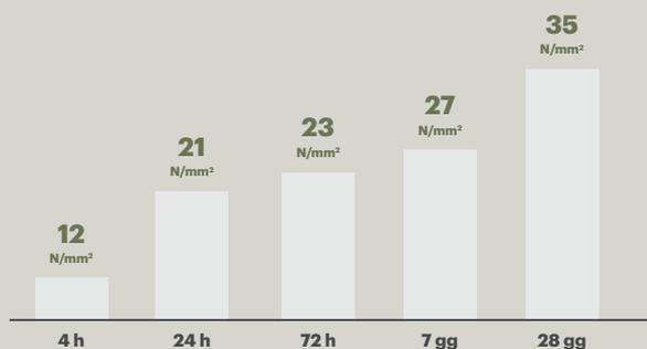
Planogel Rheo assicura fin dalle prime ore un'elevata resistenza a compressione che lo rende idoneo fin da subito alla posa della ceramica.
