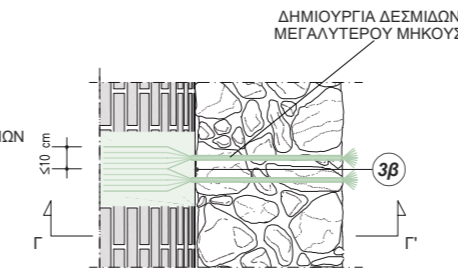
ΚΑΤΟΨΗ ΣΥΝΕΧΗΣ ΑΓΚΥΡΩΣΗ ΥΦΑΣΜΑΤΟΣ GEOSTEEL - ΕΓΚΑΤΑΣΤΑΣΗ ΣΕ ΔΙΑΜΠΕΡΕΙΣ ΟΠΕΣ
