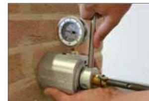
USO DO EXTRACTOR CERTIFICADO DA KERAKOLL PARA OS ENSAIOS PULL-OUT NA OBRA, PARA A VERIFICAÇÃO DA ADERÊNCIA DOS VARÕES APLICADOS
