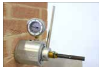
Εξοπλισμός εξόλκευσης σε λειτουργία - έλεγχος της απόδοσης των ράβδων
