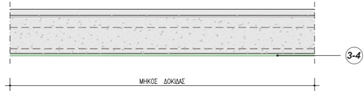
ΤΟΜΗ Β - Β' ΕΠΙΣΚΕΥΗ ΚΑΙ ΚΑΜΠΤΙΚΗ ΕΝΙΣΧΥΣΗ ΔΟΚΙΔΩΤΗΣ ΠΛΑΚΑΣ ΜΕ ΦΑΤΝΩΜΑΤΑ ΑΠΟ ΟΠΤΟΠΛΙΝΘΟΥΣ, ΜΕ ΤΟΠΟΘΕΤΗΣΗ ΧΑΛΥΒΔΟΨΦΑΣΜΑΤΟΣ GEOSTEEL G600/G1200 ΚΑΙ GEOLITE ® Η GEOSTEEL G600/1200/2000/3300 ΚΑΙ GEOLITE ® GEL
