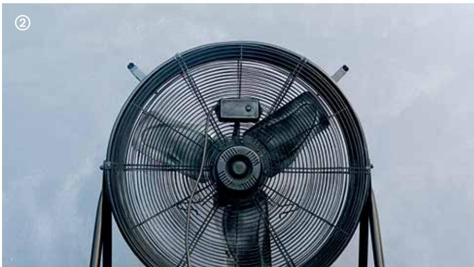
→ Para acelerar el secado del material (especialmente en ambientes húmedos y/o con poca circulación de aire) se recomienda utilizar un ventilador.
