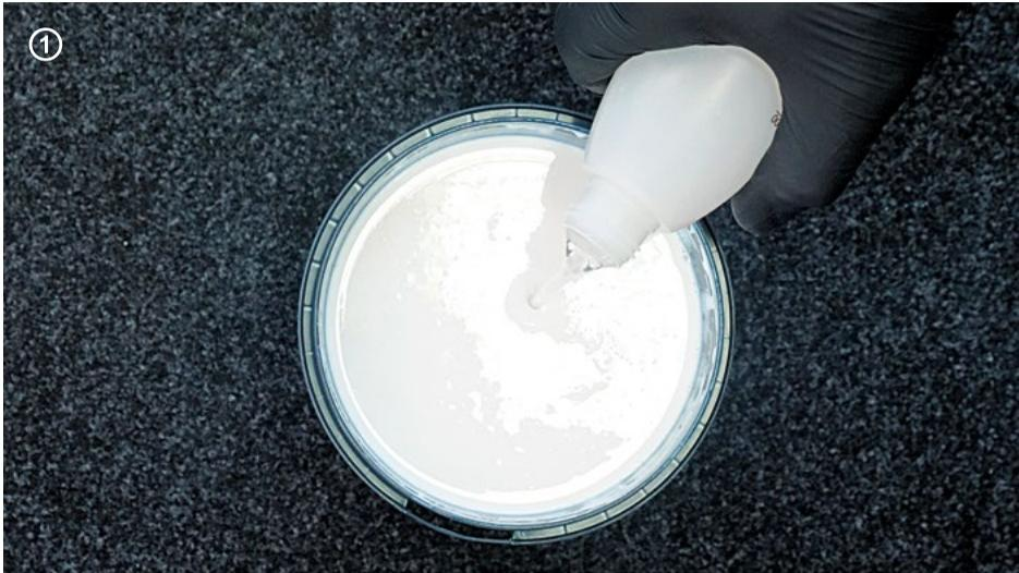
→ Mélanger la partie A avant l'utilisation, ajouter le durcisseur jusqu'au bord sous agitation selon le rapport partie A : partie B = 10 : 1.
