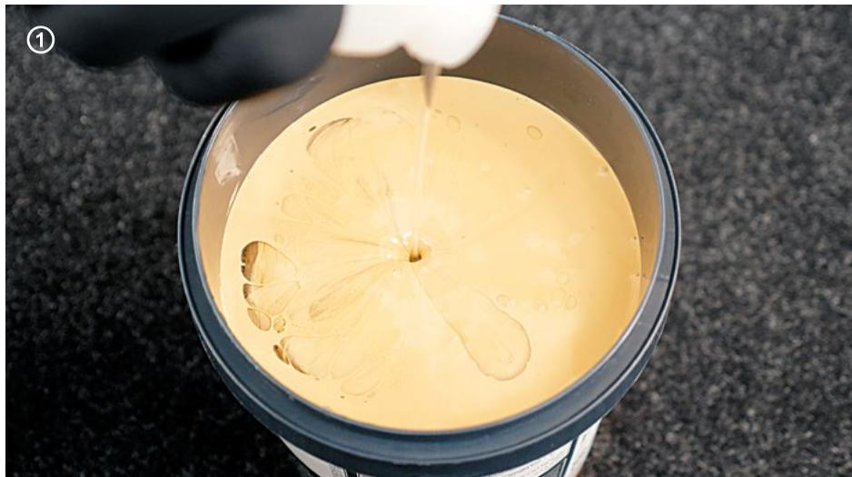
→ Mélanger la partie A avant l'utilisation, ajouter le durcisseur jusqu'au bord sous agitation selon le rapport partie A : partie B = 5 : 1. Bien mélanger, puis diluer à 10 % avec de l'eau propre et mélanger à nouveau.
