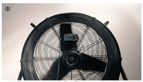
→ Pour accélérer le séchage du matériau (surtout dans les environnements humides et/ou avec peu de circulation d'air), il est conseillé d'utiliser un ventilateur.
