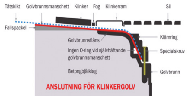
Nedan visas principskiss för skruvad klämring mot tätskiktet.
