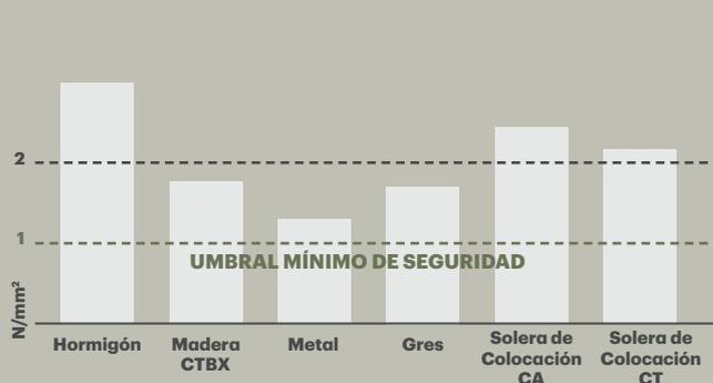
Adhesión de Planogel Rheo sobre diferentes tipologías de soportes, debidamente preparados y tratados con las imprimaciones adecuadas.
