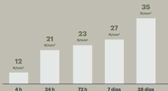
Desde las primeras horas, Planogel Rheo asegura una alta resistencia a compresión, por lo que es inmediatamente apto para la colocación de baldosas cerámicas.
