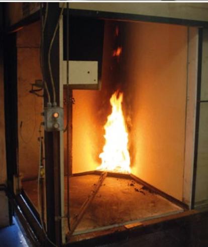
Test SBI per la determinazione della reazione al fuoco.
