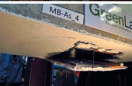
La méthode reproduit le décollement réel de la partie corticale du plancher et enregistre les charges de rupture réelles. Seuls ces essais permettent d'évaluer et de mesurer avec précision l'efficacité du renforcement appliqué.
