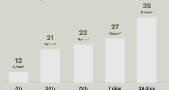
O Planogel Rheo assegura desde as primeiras horas uma elevada resistência à compressão que o torna logo adequado para a colocação de cerâmica.
